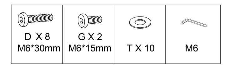
Bitte ziehen Sie die Schrauben während der Montage noch nicht fest. Die Schrauben erst in ihrer Position fixieren und am Ende der Montage alle Schrauben festziehen.
