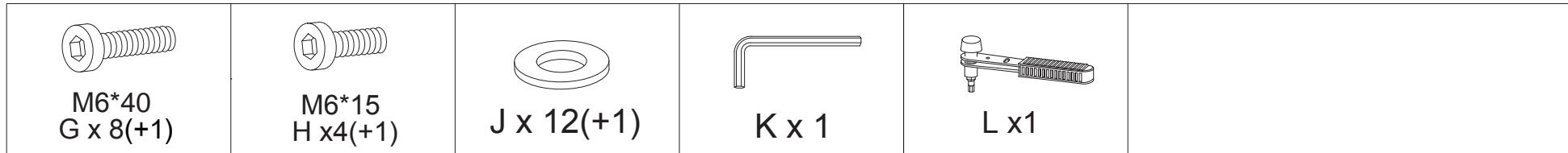
Bitte ziehen Sie die Schrauben während der Montage noch nicht fest. Die Schrauben erst in ihrer Position fixieren und am Ende der Montage alle Schrauben festziehen.
